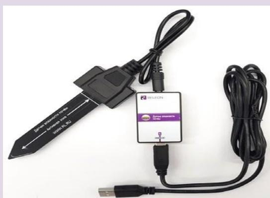
**Рис. 4.** Датчик влажности почвы
