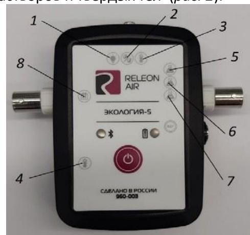
**Рис. 2.** Мультидатчик по экологии. Обозначение разъёмов и технологических отверстий:
