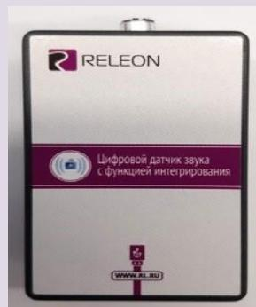
*Рис. 7* Датчик звука
