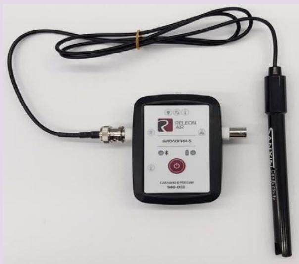
**Рис. 5.** Датчики электропроводимости
