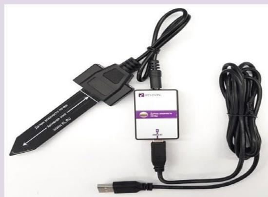
**Рис. 4.** Датчик влажности почвы
